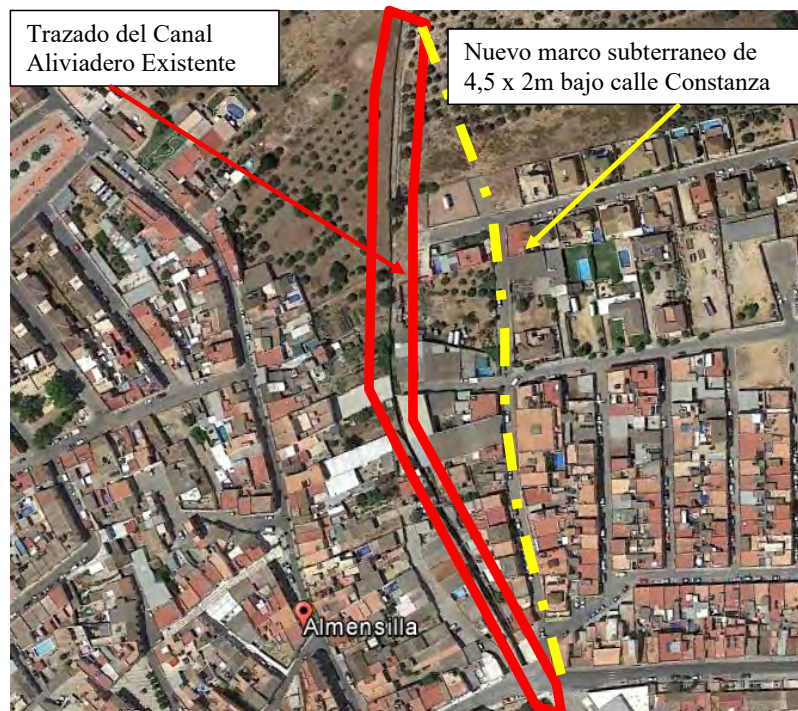
Canal Aliviadero Existente
